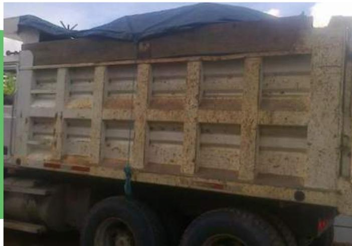
**Fig. 36:** Recubrimiento de tierra trasladada fuera de obra
